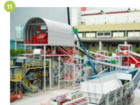
11 Mechanische Schlackeaufbereitung Singapur (SG) 600.000 Mg/a Schlacke aus Hausmüllverbrennung Baujahr 2015
