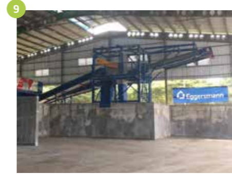
9 Eggersmann FUEL EBS-Produktion für Zementindustrie Cilacap (IDN) 40.000 Mg/a Hausmüll Baujahr 2018
