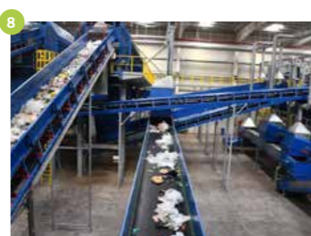
8 Recyclinganlage für Industrie-, Gewerbe- und Hausmüll Dubai (VAE) 150.000 Mg/a Hausmüll und 220.000 Mg/a Industrie- und Gewerbemüll Baujahr 2019
