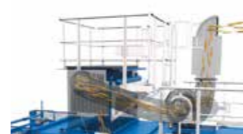
Umluftbetrieb mit Filtern
