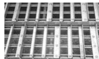
Abtrennung von Fein- und Störstoffen
