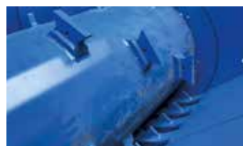
Trommel mit Spezialmitnehmern
